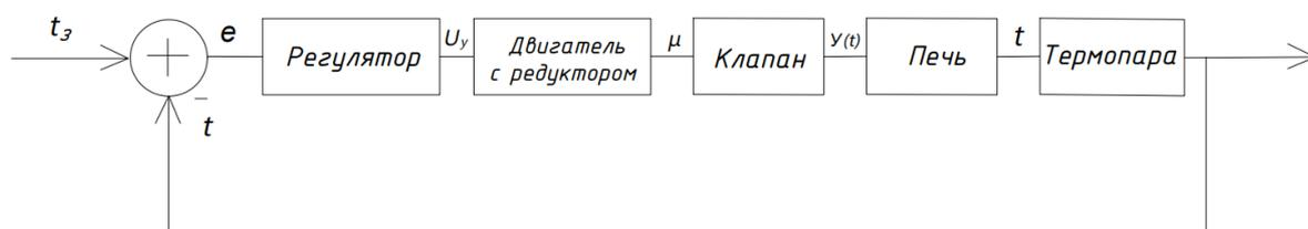
Рисунок 2.2 – Функциональная схема автоматического регулирования температурой
